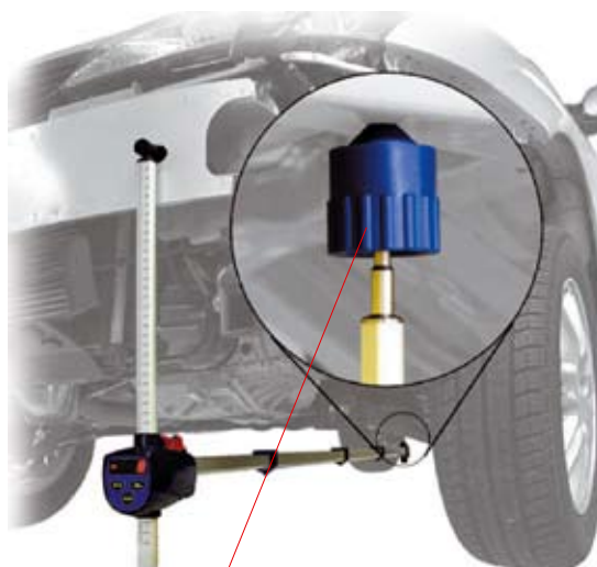
Запатентованный магнитный подвес
